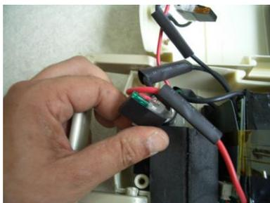
(Fusibile 2) - Rimuovere e sostituire il FUSIBILE utilizzandone uno di uguale taratura (A).
