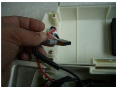
(Fusibile 1) - Rimuovere e sostituire il FUSIBILE utilizzandone uno di uguale taratura (A).
