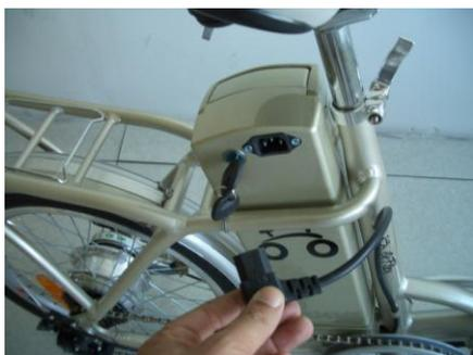
Rimuovere l'alimentazione del motore e, sganciando la sella tramite l'apposita leva sotto la stessa, rimuovere la batteria.
