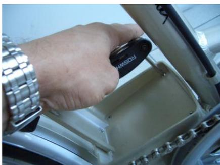
Rimuovere le viti di fissaggio del coperchio Controller utilizzando le chiavi in dotazione.
