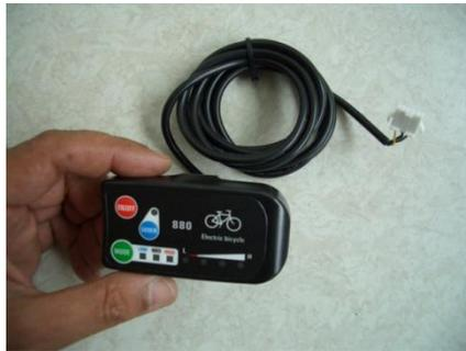
Sostituire il Display difettoso con il Ricambio ricevuto.
