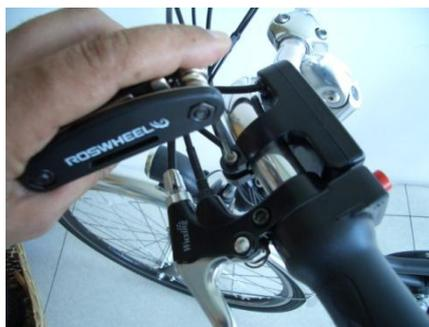
Rimuovere la vite di fissaggio del Display tramite l'apposita chiave esagonale in dotazione
