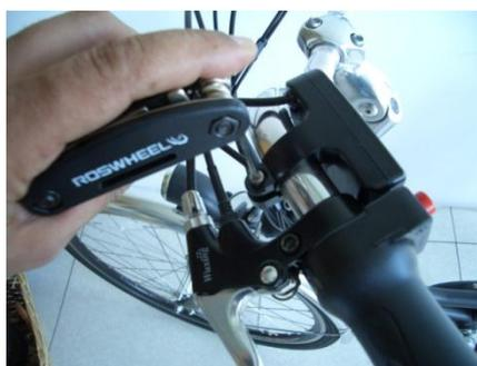
Allentare la vite di fissaggio del Display tramite l'apposita chiave esagonale in dotazione
