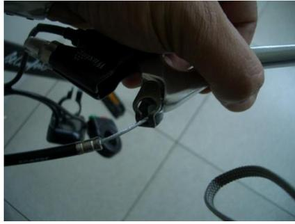
Rimuovere il cavo del freno dalle regolazioni e successivamente dalla leva del freno
