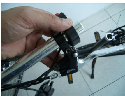
Rimuovere la manopola ruotandola, aiutatevi utilizzando un cacciavite con un po' di lubrificante. Sfilare dal Manubrio gli interruttori, la leva del freno e il Display.
