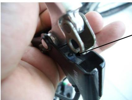
Sfilare il sensore difettoso e sostituirlo con quello inviato come ricambio.
