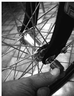
3) infilare su entrambi i lati del mozzo per prime le coppie di bloccaggio (figura).
